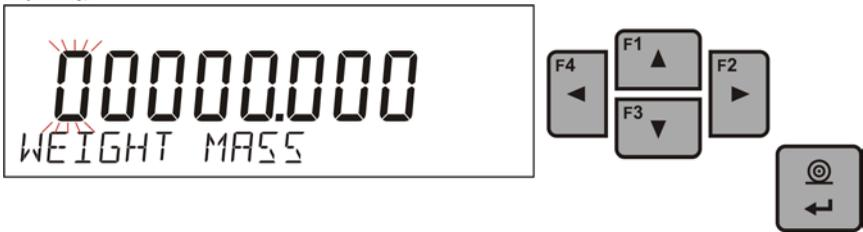
Después de introducción y comprobación del peso de la pesa patron, se mostrará el mensaje, que recomienda quitar de la carga del platillo **<QUITAR LA CARGA >** (el platillo tiene que ser vacío). Después de vaciar el platillo, pulse
