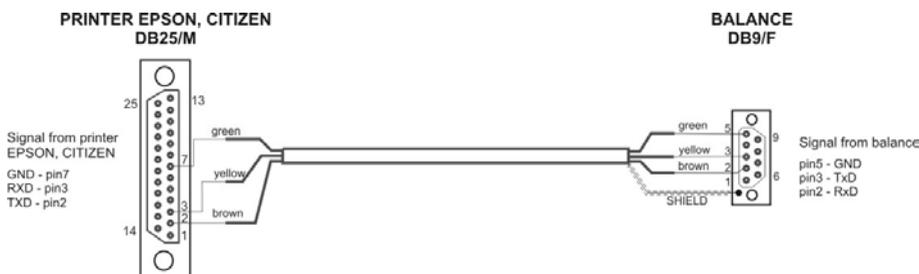
*Esquema de conducto, balanza - impresora (CITIZEN, EPSON)*
