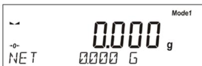
Después de seleccionar el modo, función es activa, y en la línea inferior se muestra la información sobre la masa neto (si otra información no está seleccionada por el usuario).
