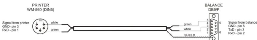
*Esquema de conducto, balanza - impresora KAFKA*
