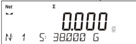
El programa guarda el peso del componente a la suma y se tarar automáticamente la indicacion (y en la pantalla principal, verá indicación de cero), y la línea inferior van a cambiar los datos sobre las cantidades de componentes y la cantidad total.
